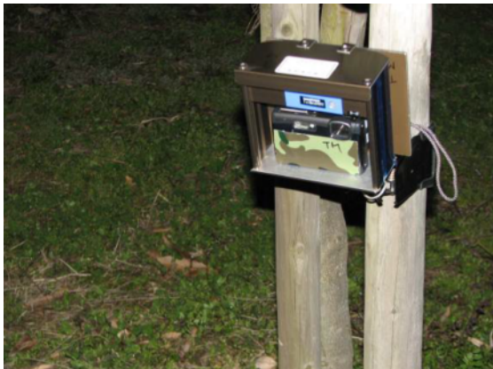
写真7 赤外線センサー付きカメラの設置
